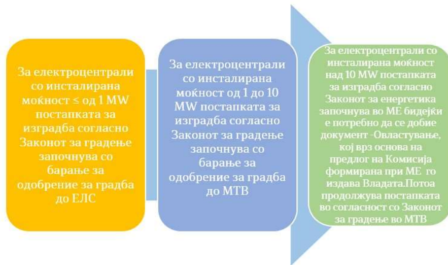
Слика број 4 – Започнување на постапка за изградба на електроцентрала од ОИЕ во зависност од моќноста
